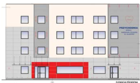
Elewacja frontowa po przebudowie na nową przychodnię przy ul. Kludy 26B
